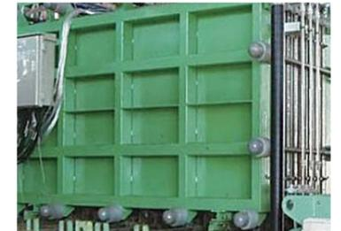
ガス拡散電極電解槽
