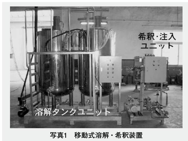
写真1 移動式溶解・希釈装置
